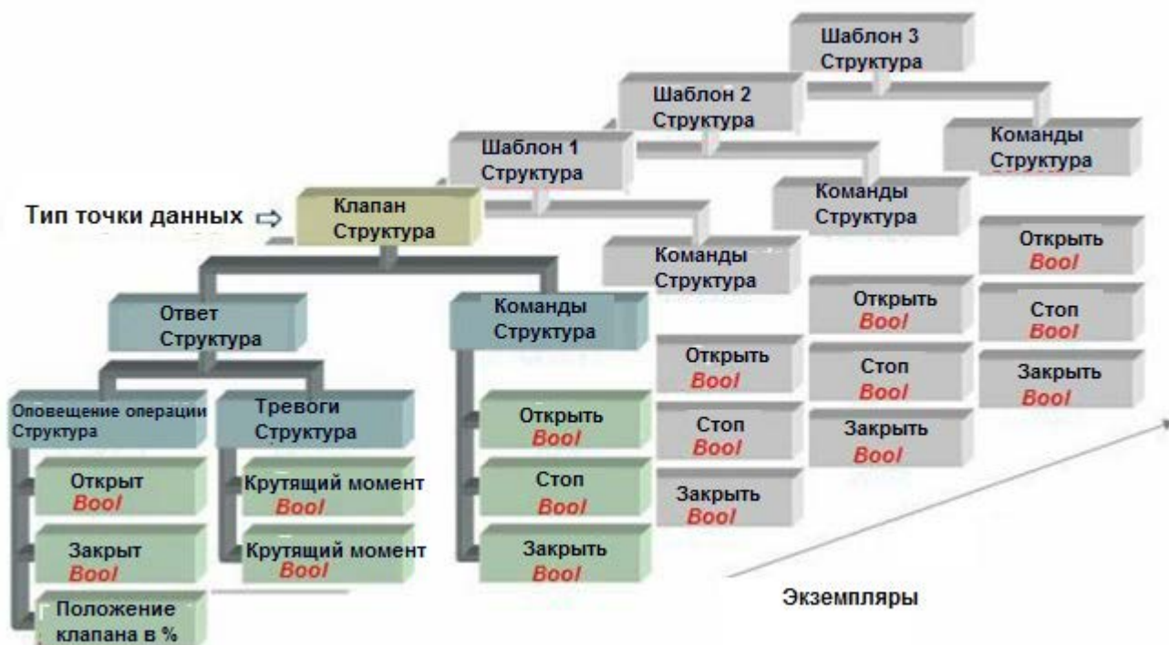
Рисунок 24 – Точки данных ползунков от 1 до 3 как экземпляры типа точки данных «клапан»
