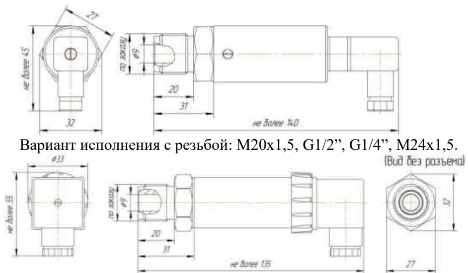
Рисунок Б.4 - Датчики ИД-Ф, вариант исполнения «с входным отверстием \varnothing 9 мм».
